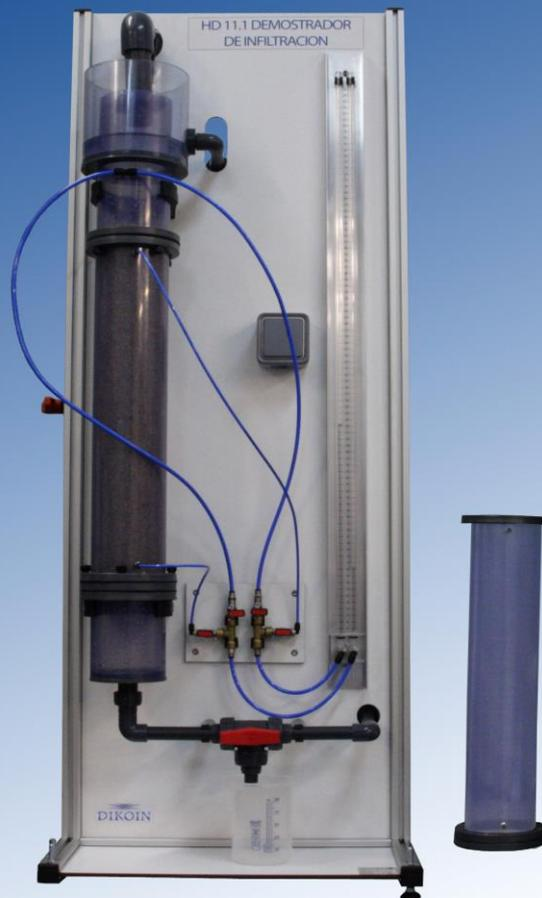
Con el equipo HD 11.1, se trata de conocer la facilidad que posee un terreno, al paso del agua por su interior, mediante la obtención de su coeficiente de permeabilidad  $k$ , aplicando la Ley de Darcy.
